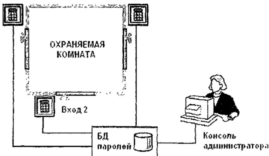
Рис. 2.72. Система ограничения доступа в охраняемую комнату
