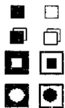
Рис. 2.67. Условные обозначения портов разных типов
