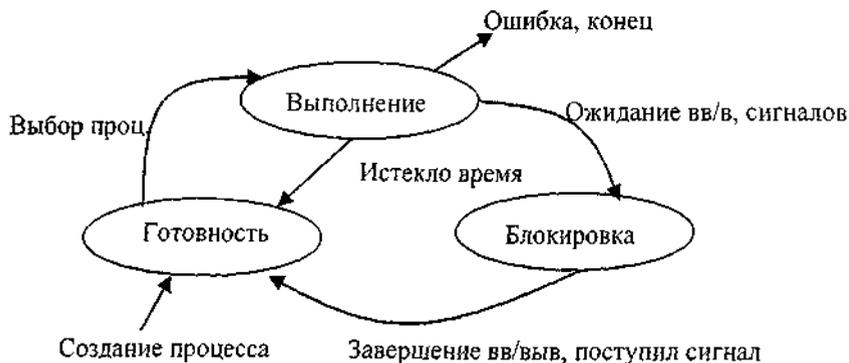
Рис. 3.4. Состояния процесса при вытесняющей многозадачности
