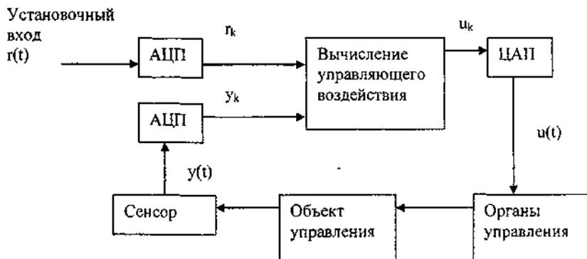
Рис. 1.2. Схема аналогового PID-контроллера
