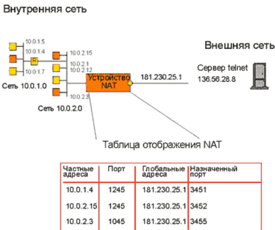
Рис. 18. Трансляция адресов и номеров портов для исходящих сессий TCP/UDP в случае NAT
