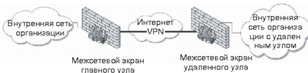
Рис. 8. Межузловое соединение VPN, проходящее через интернет
