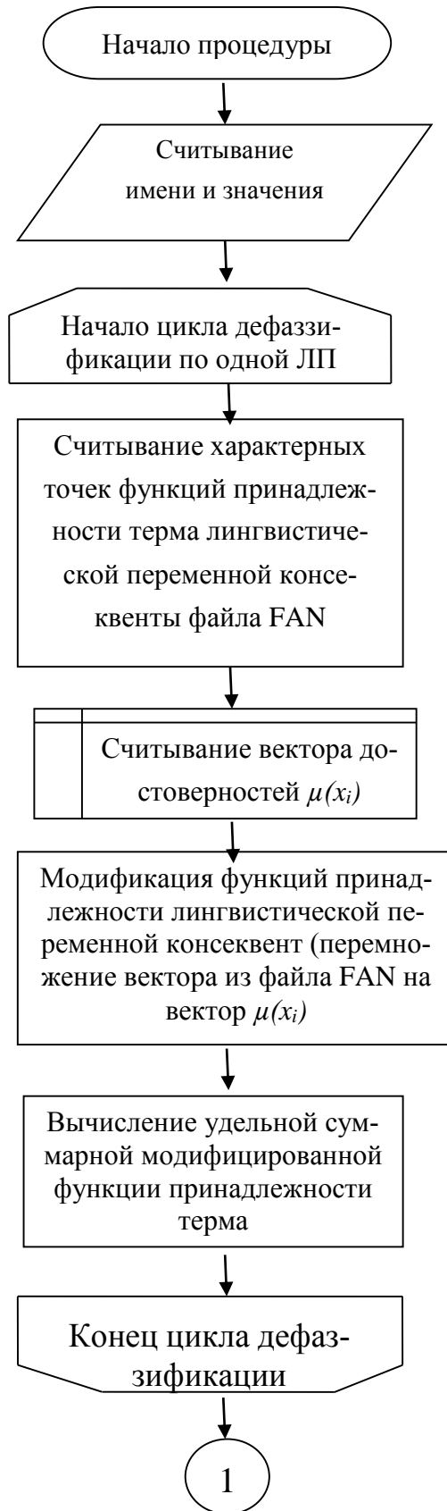
Рис. П17. Алгоритм процедуры дефаззификации для нечеткого прямого вывода (начало)
