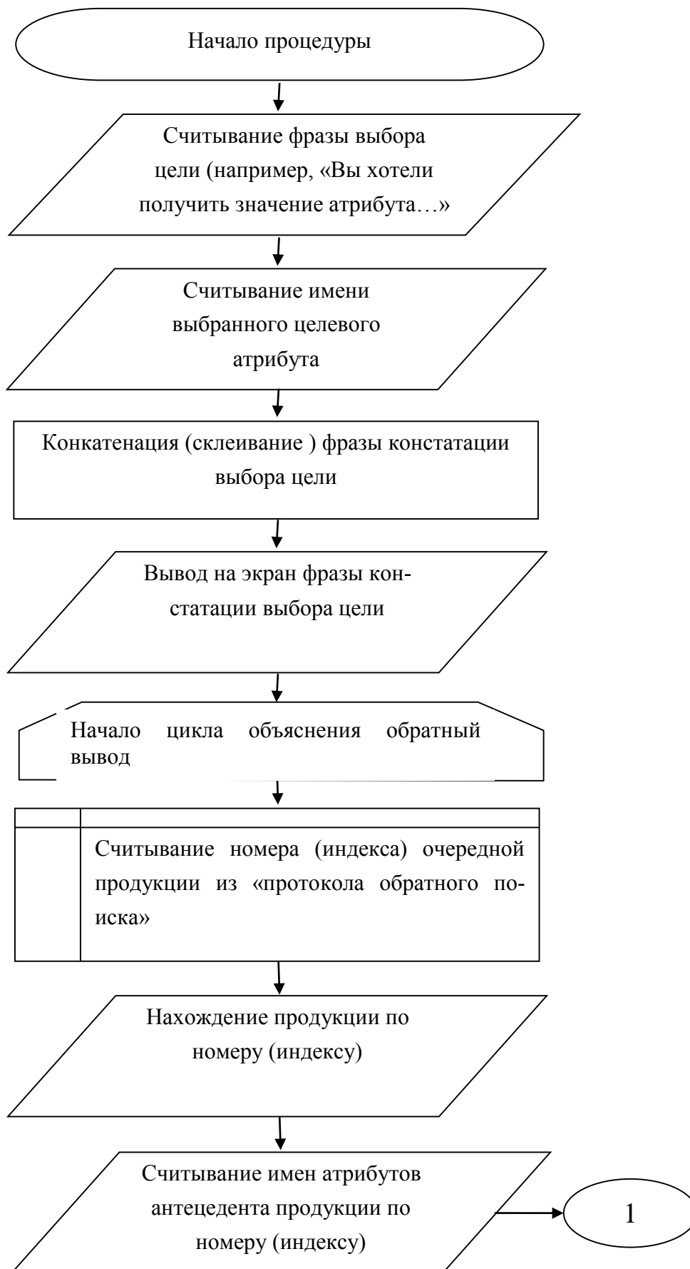
Рис. П28. Алгоритм процедуры объяснения результатов экспертизы для обратного вывода
