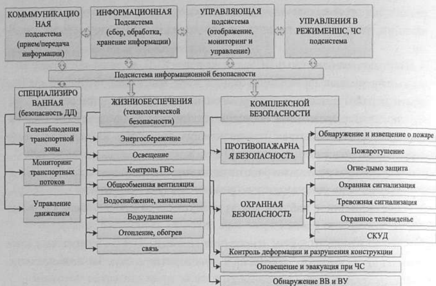
Рис. 6.2. Обобщенная структура взаимодействия компонентов ИСБ тоннельно-транспортной развязки
